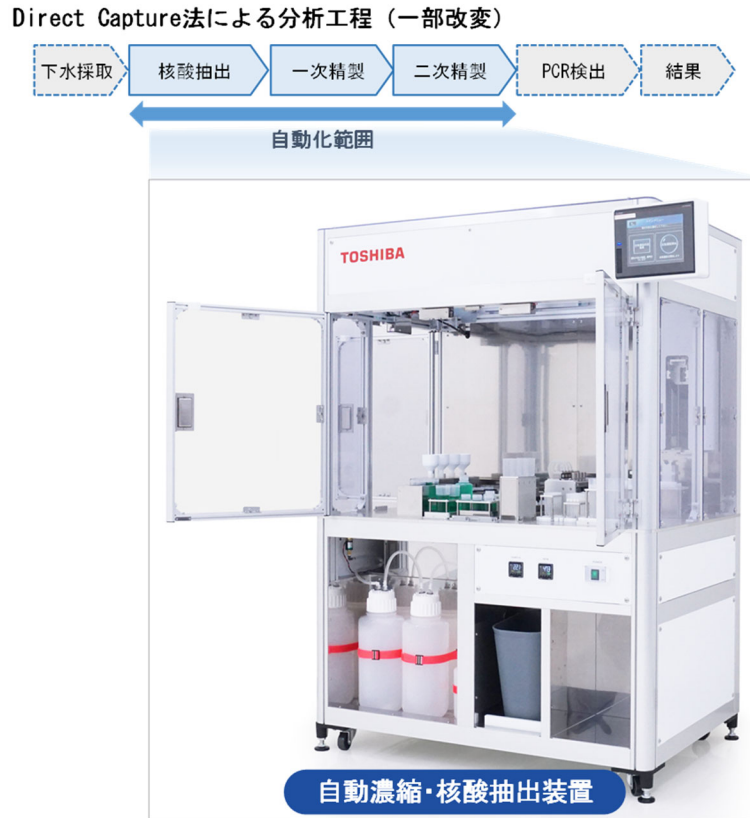
図 9. 濃縮・核酸精製自動処理装置（東芝インフラシステムズ(株)）
